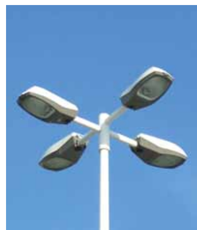
PROYECT 4 Brazos rectos dobles de longitud 1.20 m de sección rectangular para 4 proyectores. Acoplamiento en columnas de diámetro en punta 78 mm.
